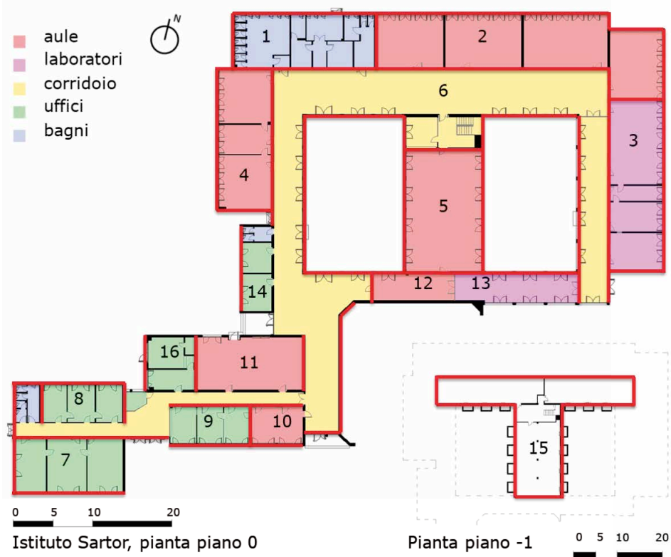
Figura 7 – Zonizzazione termica per la simulazione dinamica dell'Istituto Sartor
