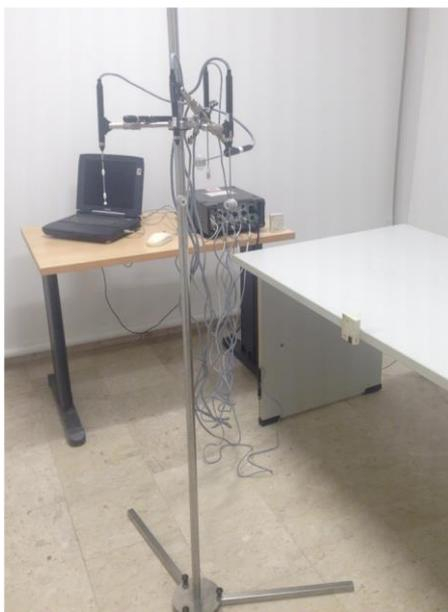
Figura 7 - Postazione di misura delle grandezze microclimatiche.
