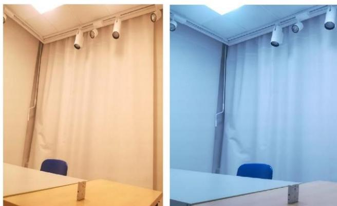
Figura 5 - Configurazioni di luce della test room. A sinistra con CCT impostata a 3000 K, a destra con CCT impostata a 6000 K.
