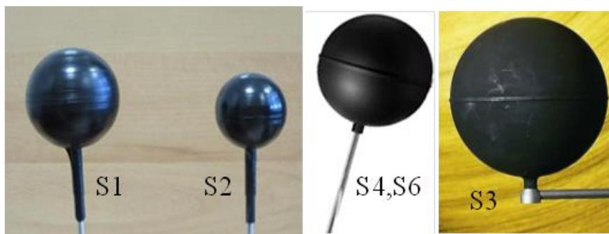
Figura 2 - I cinque globotermometri sottoposti a prova.
